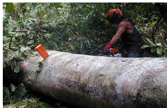
Foto 08 : Traçamento facilitado com uso de cunha - Exploração\Imagens\ traçamento com cunha.jpg (Bampton 2001)
